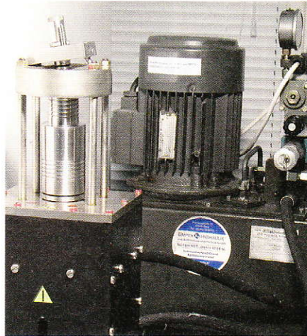
Abb. 1a: Labor-Druckhomogenisator HH20, gesamt
